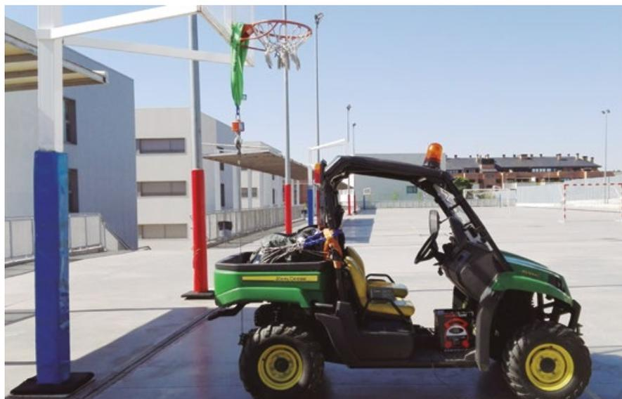
Un tractor con dinamómetro para comprobar posibles incidencias en las infraestructuras más pesadas.
